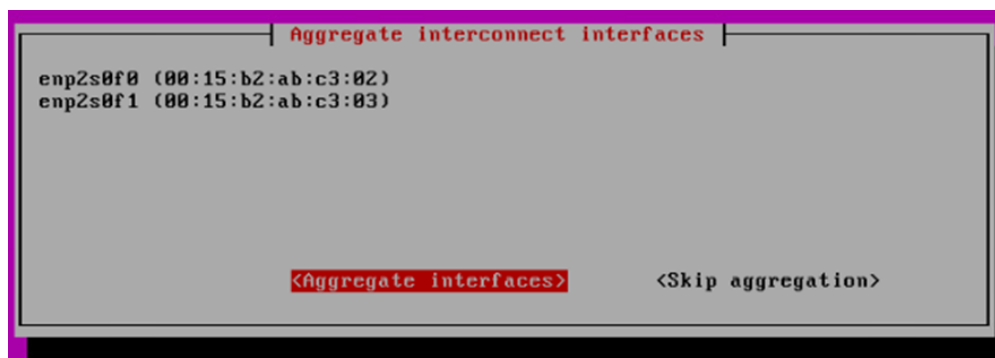
Рисунок 16. Окно агрегации интерфейсов для интерконнекта
