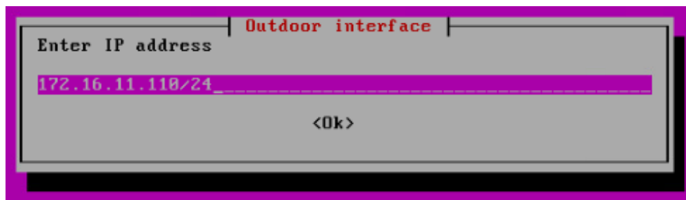
Рисунок 11. Окно ввода IP и маски для управляющего интерфейса
